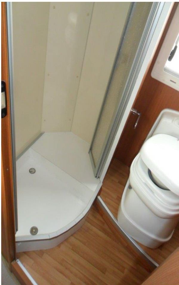
Un raro esempio di piatto doccia con doppio scarico in un camper
